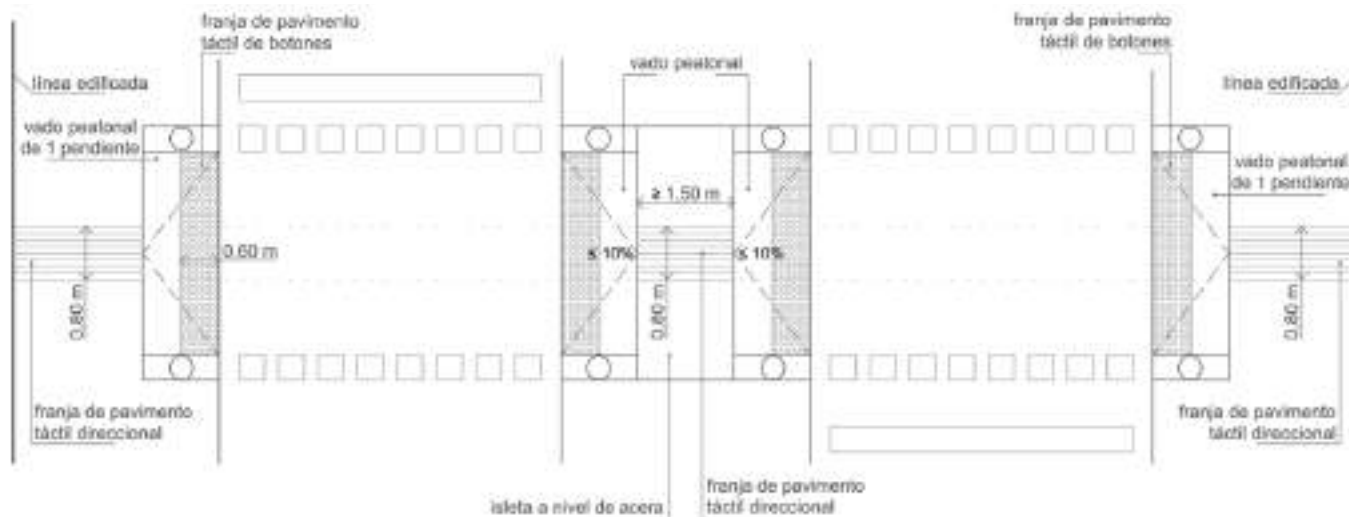
Figura 13. Cruce con isleta al mismo nivel de las aceras: ejemplo de aplicación de la señalización táctil
